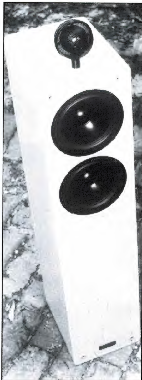
Foto 2. De Lambda 10 met bovenop de zuil het roemruchte Magnat-bolle-tje. Door een nauwkeurig bepaalde hoogte/breedteverhouding van de zuil vertonen ook de woofers een gelijkmatige rondomkarakteristiek.
